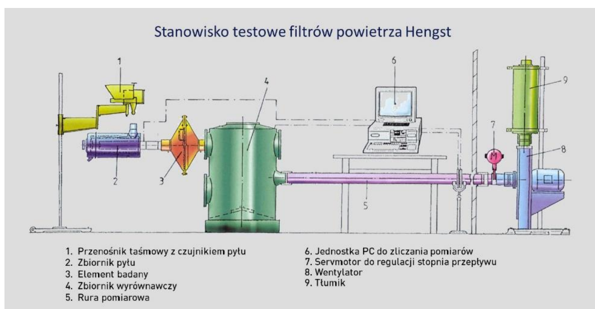
Fot. Stanowisko testowe filtrów powietrza Hengst.
